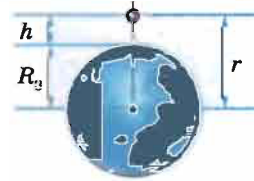
Рис. 21.1. Відстань r від центра Землі до тіла дорівнює сумі радіуса Землі R_3 і висоти h , на якій міститься тіло над поверхнею Землі
